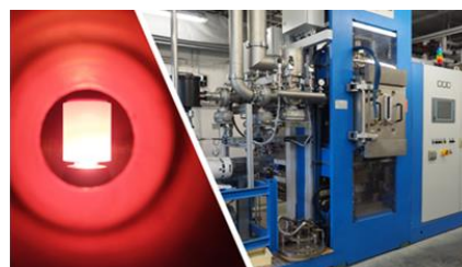
Abbildung 1: SPS-Anlage mit Sinterkammer.
