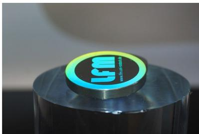
Lichtbrechung an strukturierten Oberflächen
