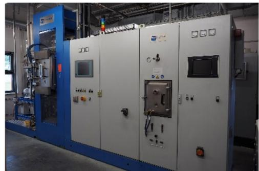
Abb. 2: FAST/SPS Anlage
