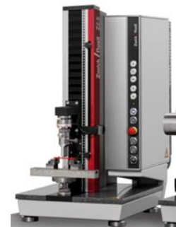
Abbildung 2: Universalprüfmaschine Zwick/Roell Z5.0 mit dem Aufbau zur Prüfung der Biegefestigkeit
