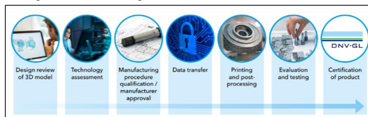
Zertifizierungsablauf für die additive Fertigung (Quelle: DNV GL)
