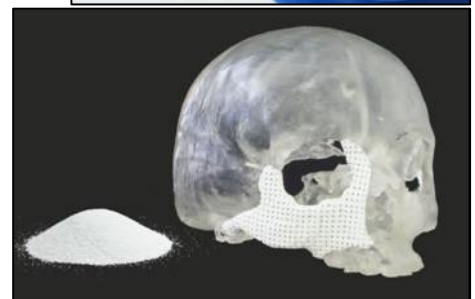
oben: 3D-gedrucktes Stirnhöhlenimplantat (Quelle: LFM)
