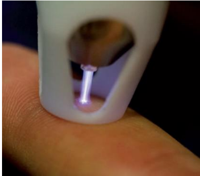
Abbildung 1: Plasmajet zur Hautzellbehandlung bei Atmosphärendruck
