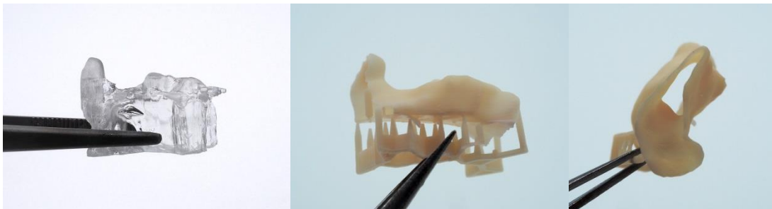
Abb.: Prototyp eines anatomisch angepassten Stirnhöhlenimplantats, 3D-gedruckt an der DLP-Anlage EnvisionTEC VIDA. (1): Material PEGDA, (2) u. (3): Material E-Model Light (Standardmaterial für die VIDA-Anlage). Aufgrund fehlender UV-Blocker können Hohlstrukturen noch nicht aus PEGDA gefertigt werden. Diese Problematik stellt einen Schwerpunkt dieser Arbeit.
