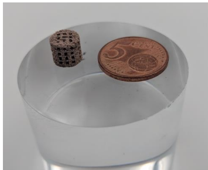
Abb.: additiv gefertigte Piezokeramik
